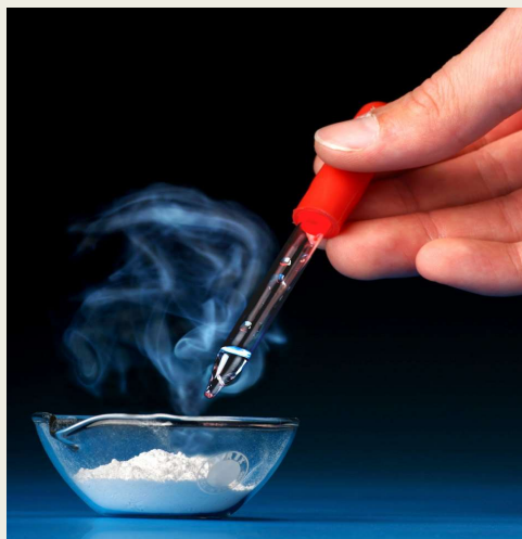
Reakcija kalcijevog oksida s vodom je egzotermna kemijska reakcija
